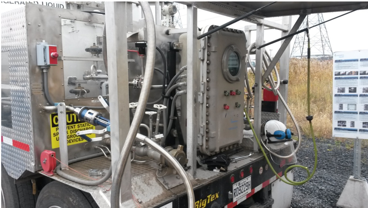
Figure 5: LNG mobile filling station, back section with meter, delivery hose, and HMI. / Station mobile de remplissage GNL, section arrière avec le compteur, le boyau et le HMI
