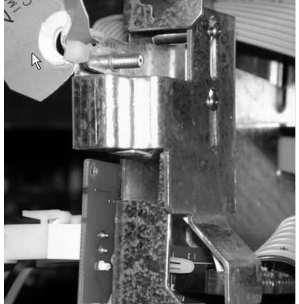
Figure 3 Security switch Normal/Sealed position | Position Normal/Scellé de l'interrupteur de sécurité.
