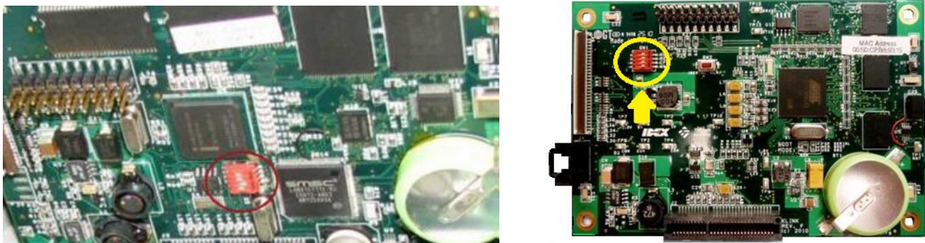
Figure 9 DIP switches for Program / W&M access; rev. 1.0 on old CPU board (left) and rev 2.1 on new CPU board (right) | Interrupteurs DIP pour l'accès du mode « Program » et « W&M »; rév. 1.0 sur l'ancienne carte de CPU (gauche) et rév. 2.1 sur la nouvelle carte CPU (droit)
