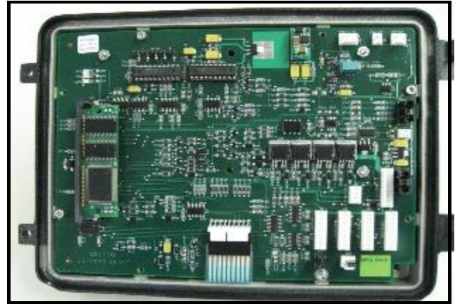
Figure 5: E:Count MCR-05 circuit board with piggyback circuit incorporated into the main board | Carte de circuits imprimés du E:Count MCR-05 avec carte ferroutière incorpore dans la carte primaire.
