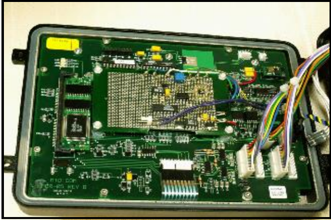
Figure 4: E:Count MCR-05 circuit board with new electronic components for the temperature probe | Carte de circuits imprimés du E:Count MCR-05 avec composantes électroniques pour la nouvelle sonde thermométrique.
