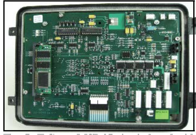
Figure 5 E:Count MCR-05 circuit board with piggyback circuit incorporated into the main board | Carte de circuits imprimés du E:Count MCR-05 avec carte ferroutière incorpore dans la carte primaire.
