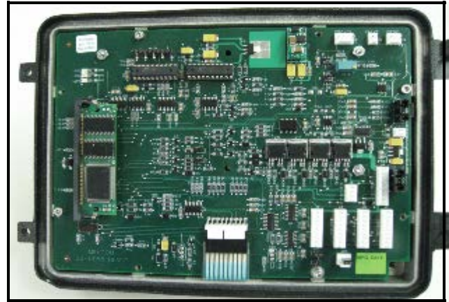
Fig. 5: E:Count MCR-05 circuit board with piggyback circuit incorporated into the main board/ Carte de circuits imprimés du E:Count avec carte ferroutière incorporé dans la carte primaire.
