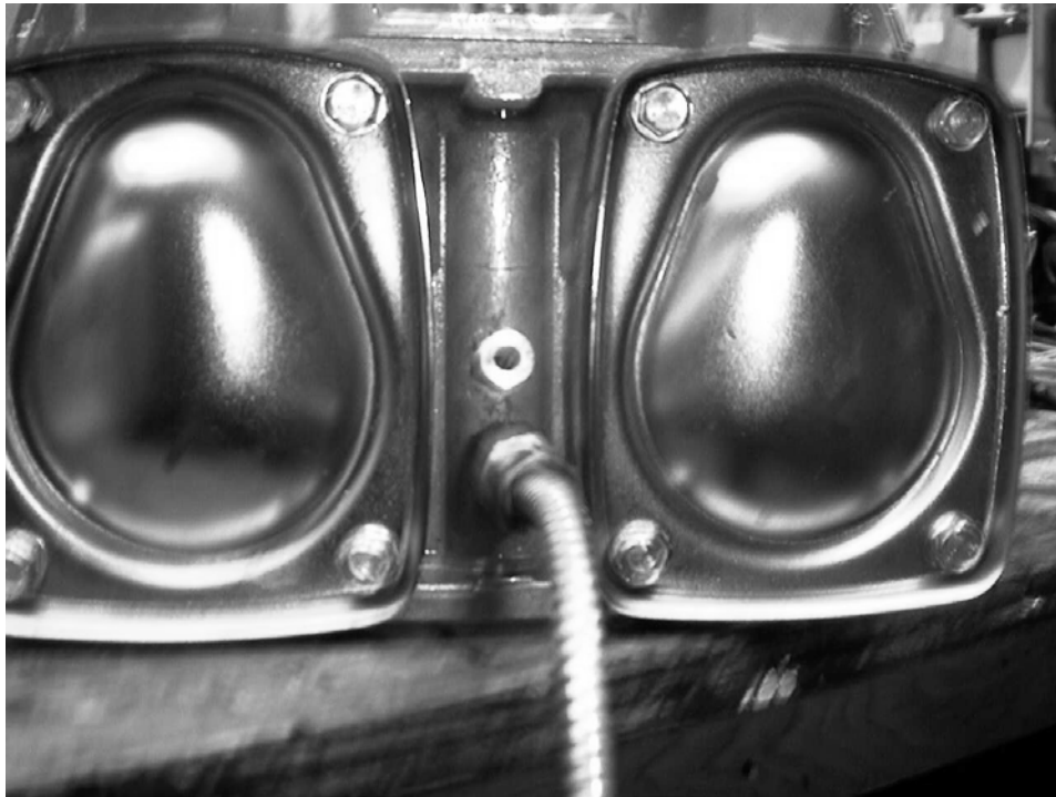
Fig. 2: Side view of iMETER with ATC probe and thermowell / Vue latérale de l' iMETER avec sonde et puits thermométrique du CAT
