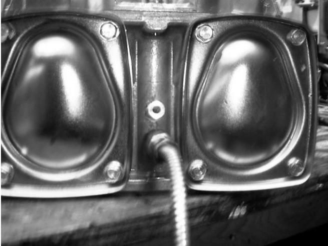
Fig. 4: Side view of the iMETER with ATC probe and thermal well. | Vue latérale de l' iMETER avec sonde et puits thermométrique du CAT.
