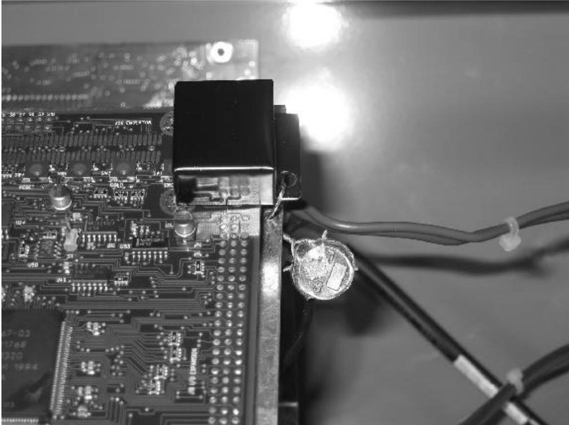
**Switch Cover Seal / Sceau du couvercle de l'interrupteur**
