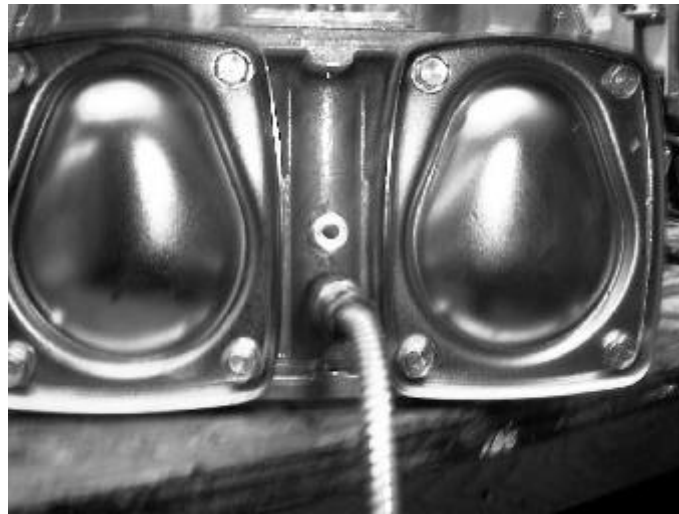
Fig. 2: Side view of iMETER with ATC probe and thermowell / Vue latérale du iMETER avec sonde du CAT et le puits thermométrique
