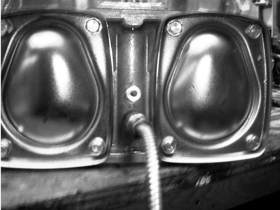
Figure 2: Side view of iMETER with ATC probe and thermowell | Vue latérale du iMETER avec la sonde du CAT et le puits thermométrique.
