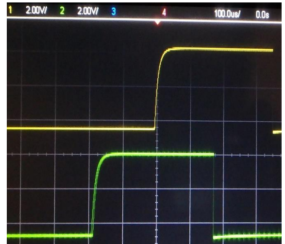
Figure 4 Typical output dual pulse signal from the SCL board. | Sortie représentative du signal impulsion double de la carte SCL.
