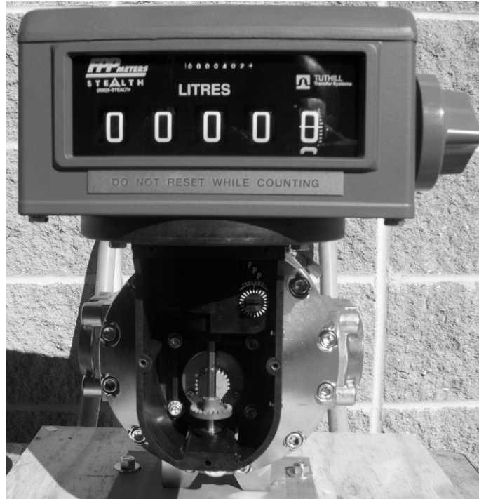
Figure 2 Mechanical calibrator and mechanical drive mechanism | étalonneur mécanique et mécanisme d'entraînement.
