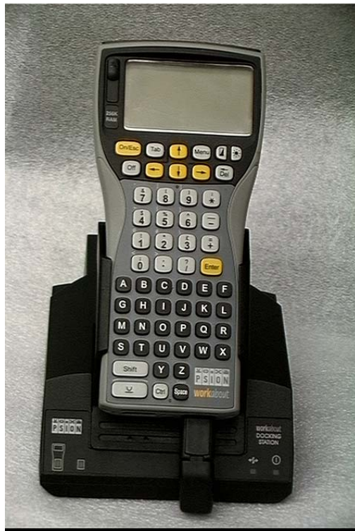
Fig. 1 PSION portable communicator with docking station Communicateur portatif PSION avec station d'accueil
