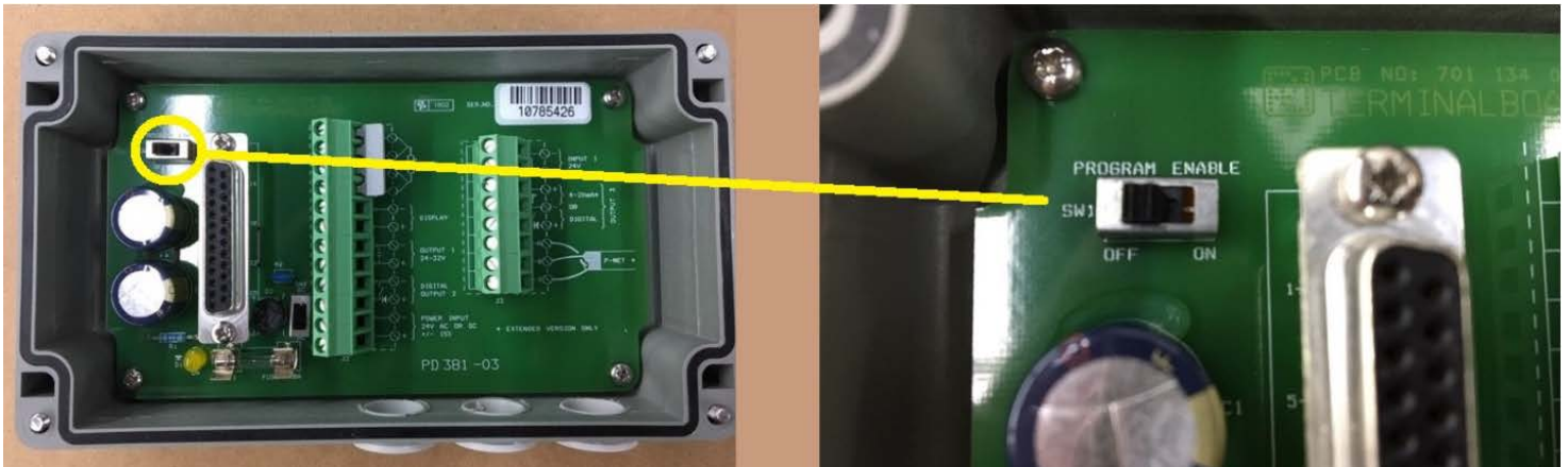
Figure 2 : Sealed position for “Program Enable” switch (OFF) | La position scellée (OFF) du commutateur « Program Enable »
