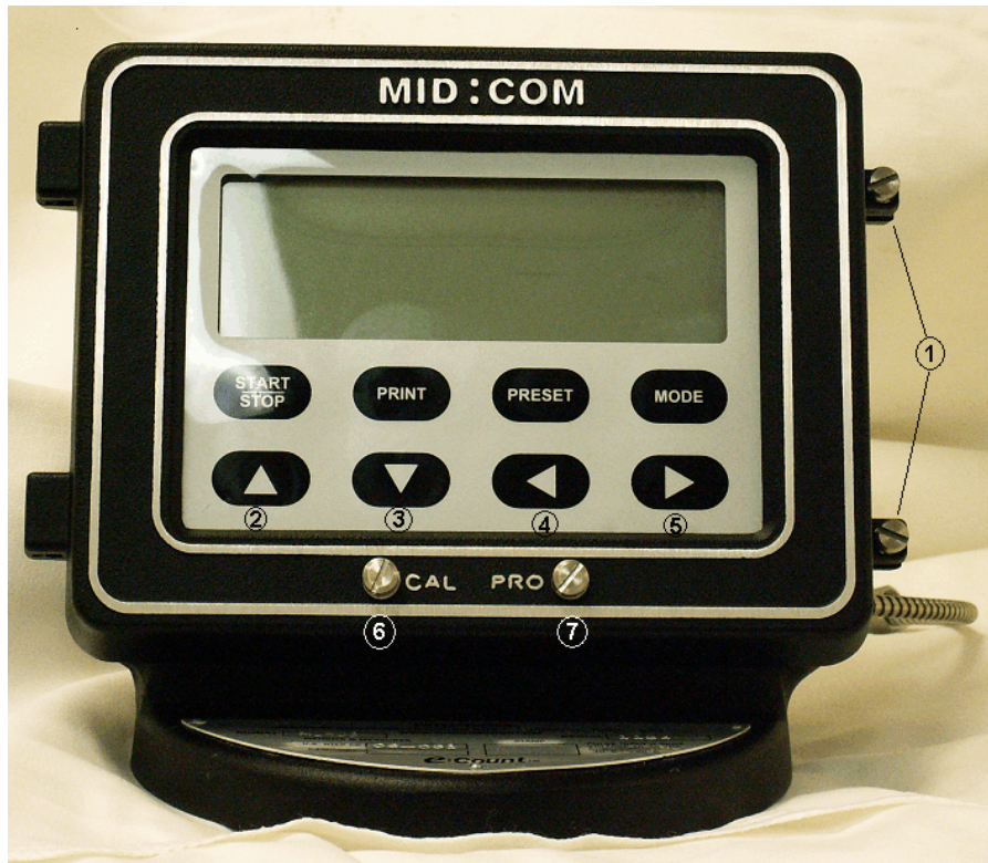
Figure 3: E:Count Electronic Register / L'enregistreur électronique E:Count
