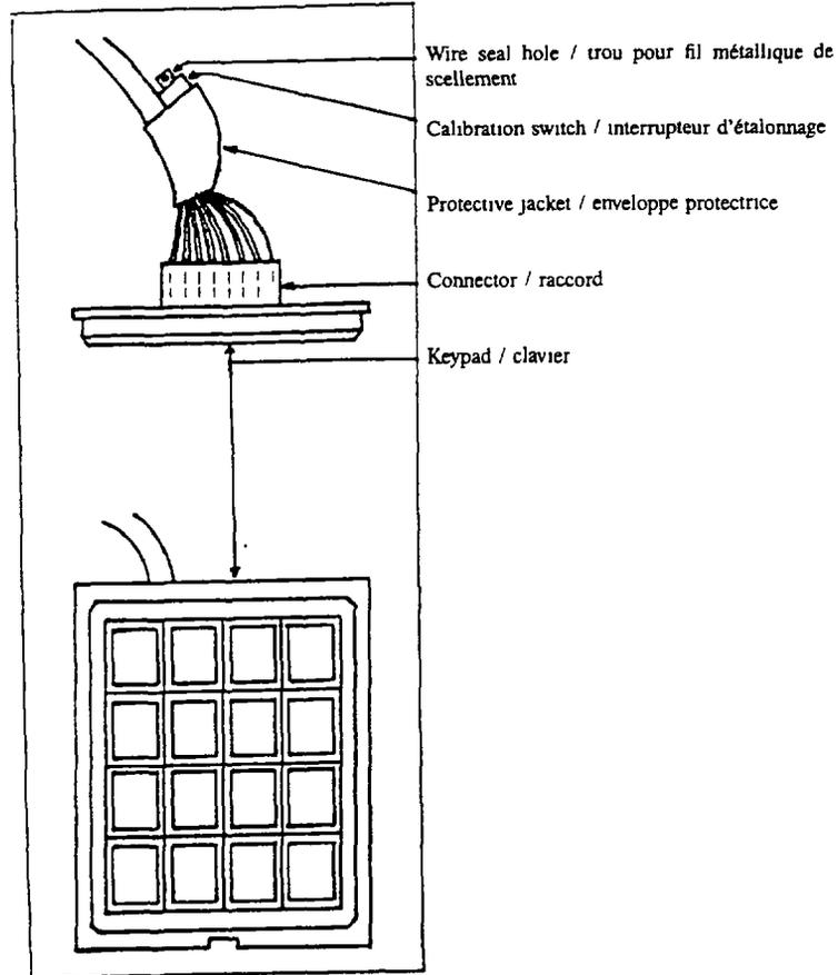
Location of calibration switch for 203 SPHC, 203 SPHC and 203 SPHTC / Emplacement de l'interrupteur d'étalonnage pour 203 SPHC, 203 SPHC et 203 SPHTC
