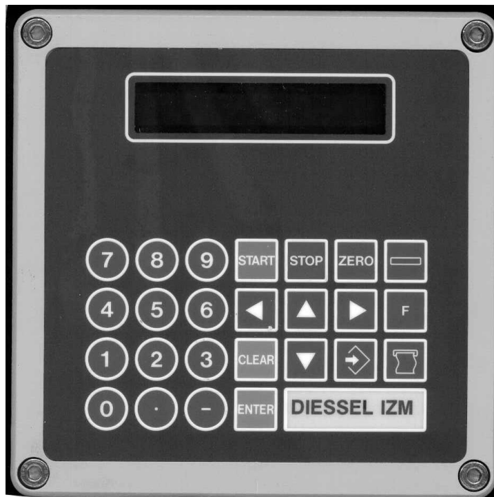
Figure 5: IZMSE / IZMTE electronic register | Figure 5 : L'enregistreur électronique d' IZMSE et d' IZMTE
