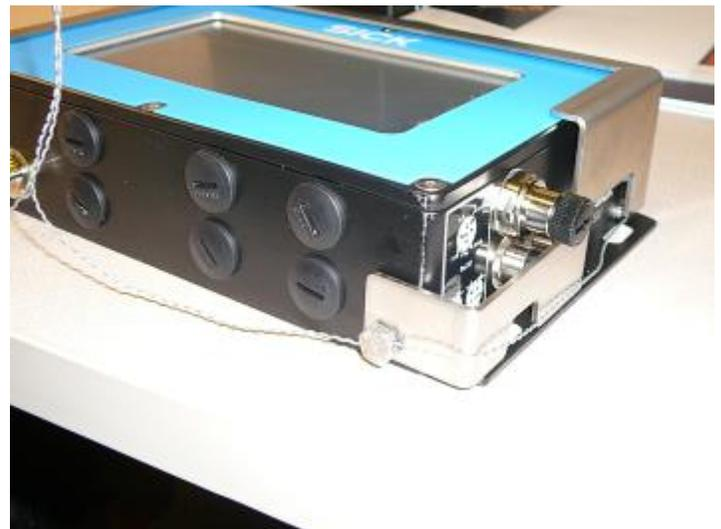
Typical Sealing (3 Drilled-head Screws) / Scellage Typique (3 vis à têtes percées)
