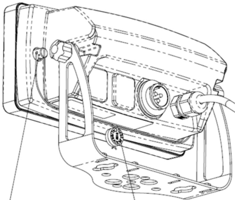
Back cover must be sealed with two cross-drilled security screws with wire and lead seal. / Le couvercle arrière doit être scellé à l'aide de deux vis de sécurité percées en croix et munies d'un sceau pour le fil et le plomb.
