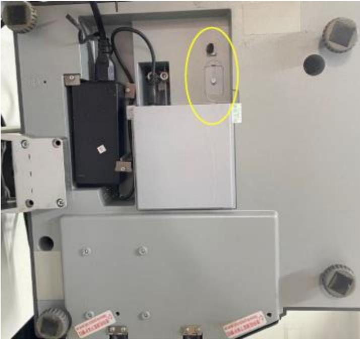
**Typical Sealing Location / Emplacement typique du scellement**
