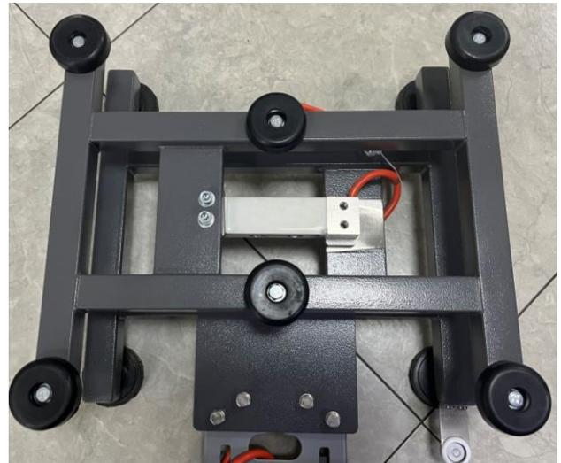
**Typical Sub-platter for "R" Models / Sous-plateau typique pour les modèles « R »**
