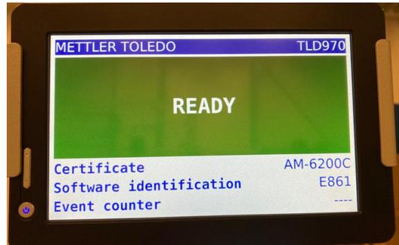
**Typical USB Display and ready condition (Height offset is non legal for trade and has not been evaluated by Measurement Canada)/ Afficheur USB typique et état prêt (Le offset de hauteur n'est pas légal pour le commerce et n'a pas été évalué par Mesures Canada.)**
