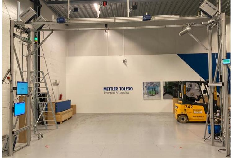
**Typical Dimensioning Arrangement for TLD970/ Disposition typique de dimensionnement pour le TLD970**
