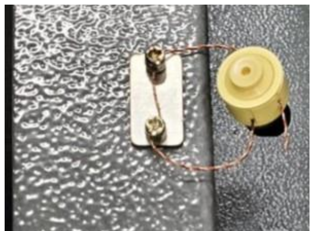
Typical sealing of calibration switch / Scellement typique de commutateur d'étalonnage
