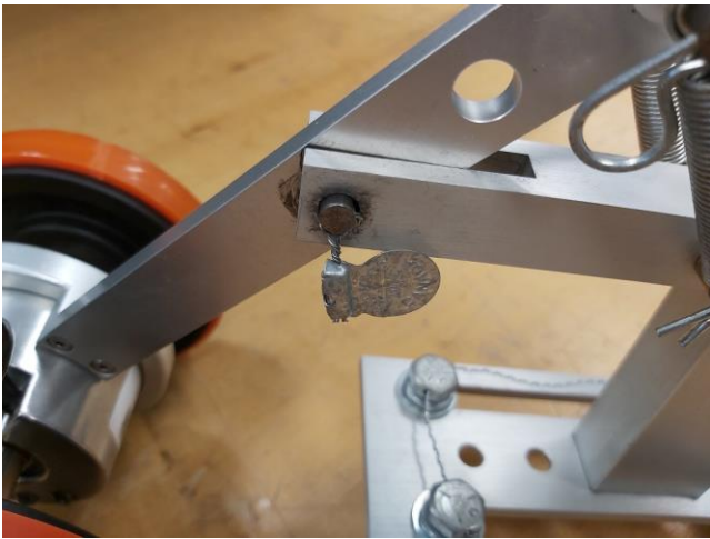
Figure 5 Typical tachometer sealing / Scellage typique du tachymètre
