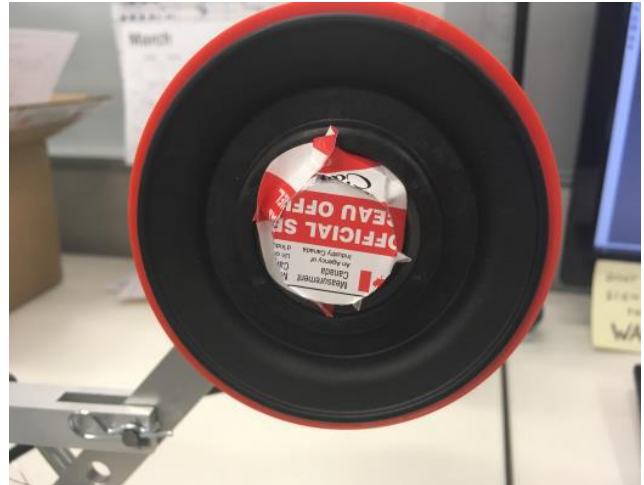
Figure 5 Typical tachometer sealing / Scellage typique du tachymètre
