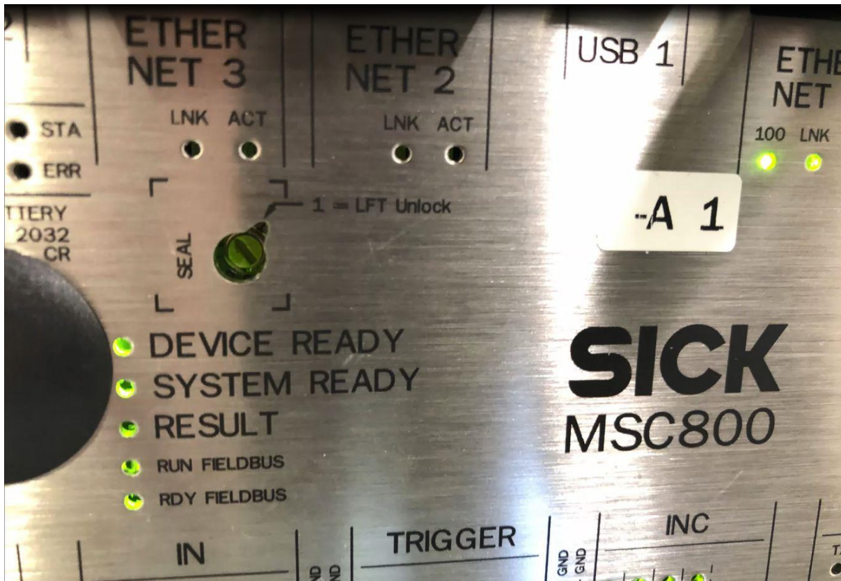
MSC800 controller with location of rotary sealing switch in the sealed position / Contrôleur MSC800 avec l'emplacement du commutateur rotatif de scellage dans la position scellé
