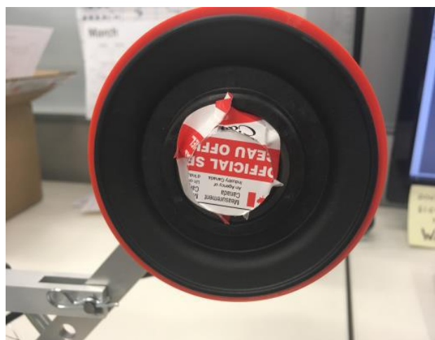
Figure 6 Typical tachometer sealing for unidirectional measurements/ Scellage typique du tachymètre pour mesures unidirectionnel
