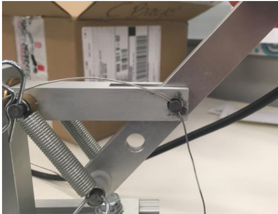
Typical tachometer sealing / Scellage typique du tachymètre
