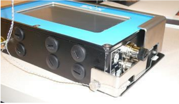
Typical sealing for the SIU display / Scellage typique pour l'affichage SIU
