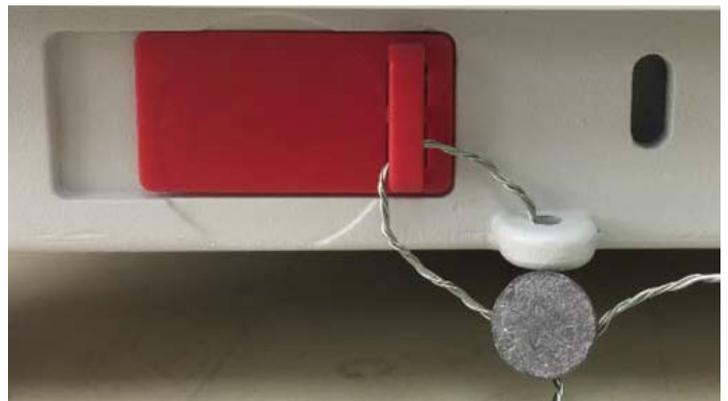
**Typical PJXyNz sealing and switch position on back of device / Scellage et position du commutateur PJXyNz typiques à l'arrière de l'appareil**
