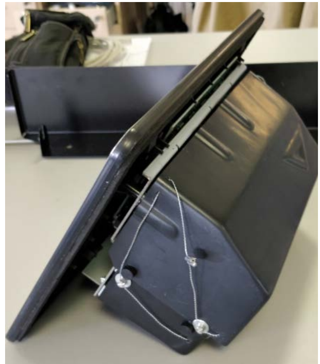
Typical I410-D-Q sealing on both sides of device / Scellage typique I410-D-Q des deux côtés de l'appareil
