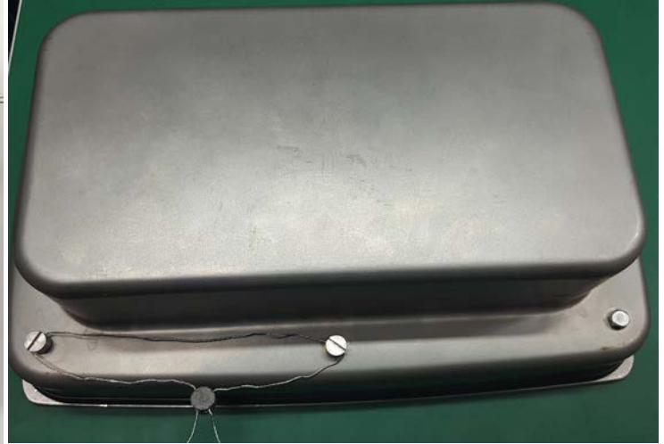
Typical sealing method of model TD52XW / Méthode de scellage typique du modèle TD52XW
