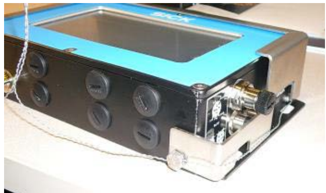
Typical display sealing (3 drilled-head screws) / Scellage typique de l'afficheur (3 vis à têtes percées)
