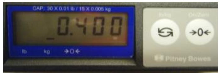
Typical operator's display (segmented LCD) / Affichage typique destiné à l'opérateur (ACL segmenté)
