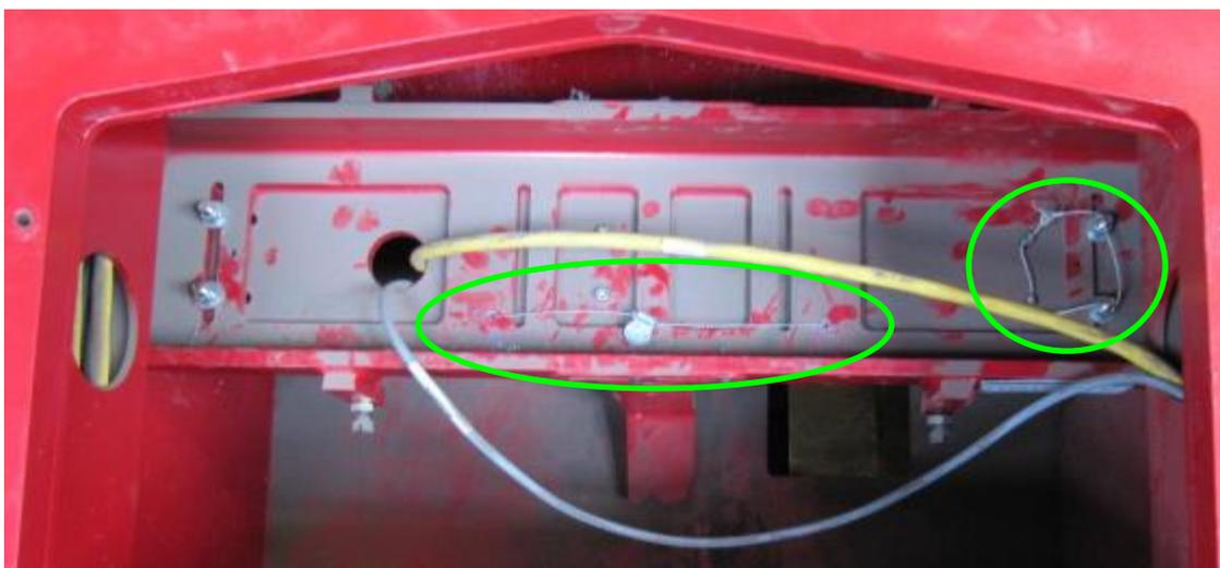
**Typical sensor head sealing (circled screws and holes) / Scellage typique des capteurs (vis et trous encerclées)**
