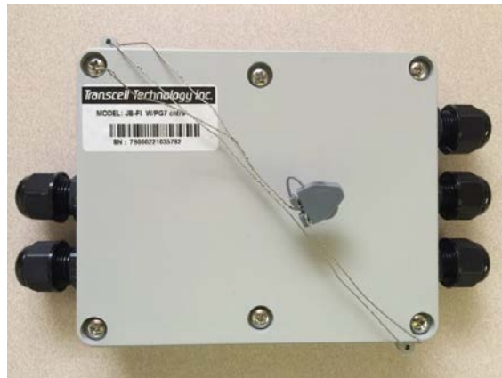
Typical Sealing of the junction box / Scellage typique de la boîte de jonction
