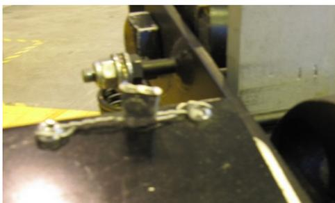
**Typical wire and seal method / Méthode typique de scellage avec fil et scellé**
