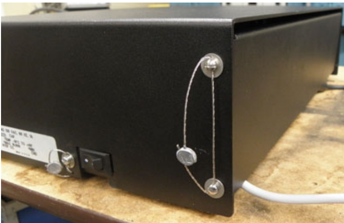
Typical rear sealing for model 2700 / Scellage de l'arrière du modèle 2700 typique
