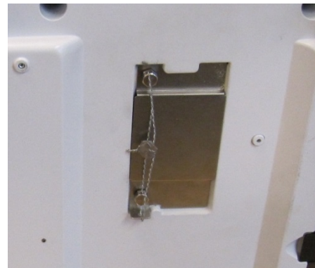
Typical calibration switch sealing under device / Scellage typique du commutateur de calibration sous l'appareil
