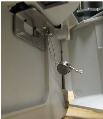
Typical SD card sealing under the operator's keyboard / Scellage typique de la carte SD sous le clavier de l'opérateur
