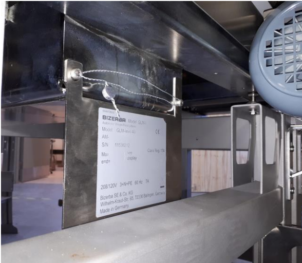
Typical sealing under the scale of model GLM-I G5 40 and GLM-Ievo 40 / Scellage typique sous la balance du modèle GLM-I G5 40 et GLM-Ievo 40
