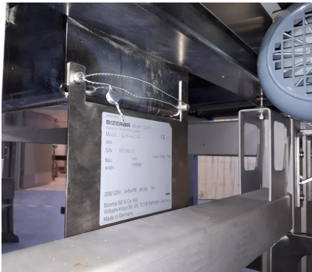
Typical sealing under the scale of model GLM-Ievo 40 / Scellage typique sous la balance du modèle GLM-Ievo 40
