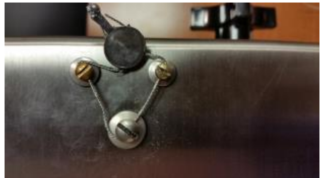
Typical sealing on model 1280-2y / Scellage typique pour le modèle 1280-2y
