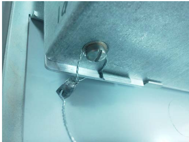
Typical sealing on model 1280-3A, 1280-3D, 1280-4A or 1280-4D. / Scellage typique pour le modèle 1280-3A, 1280-3D, 1280-4A ou 1280-4D.
