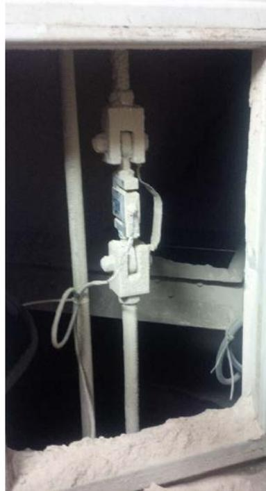
**Typical load cell / Cellule de passage typique**
