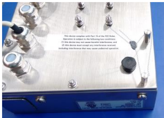
Typical sealing method / Méthode de scellage typique
