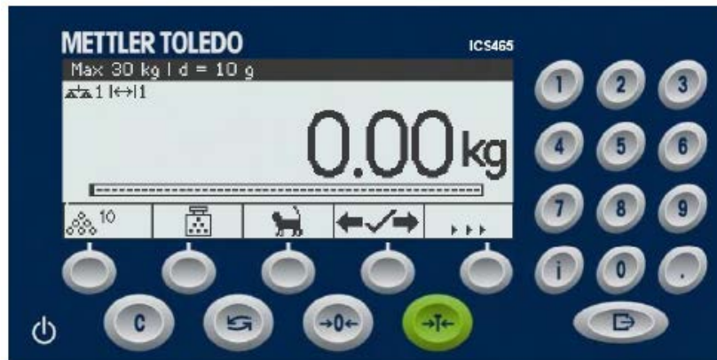
Typical model ICS465 display and controls. Other models have fewer keys. / Affichage et clavier d'un modèle ICS465 typique. Les autres modèles ont moins de touches.
