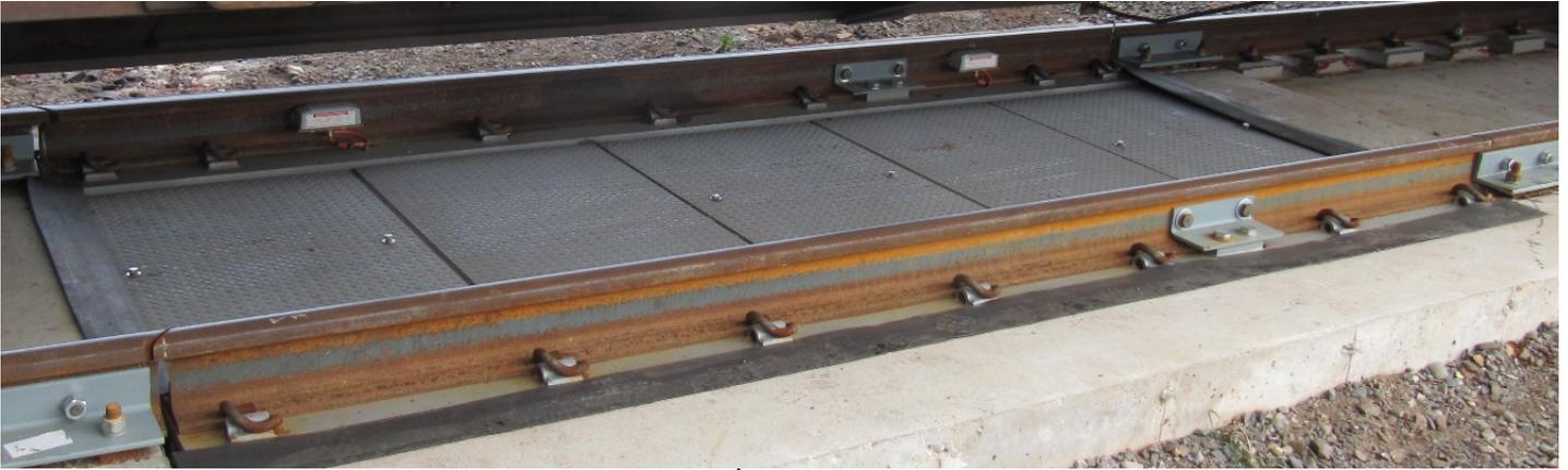
**Typical weighing element / Élément récepteur de charge typique**
