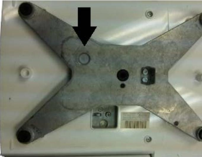
Typical sub-platter and sealing location for the KH II 100-#, KH II 200-# and KH II 800-# models. The arrow shows the calibration switch location. / Sous-plateau et emplacement du scellé typiques pour les modèles KH II 100-#, KH II 200-# et KH II 800-#. La flèche démontre l'emplacement de l'interrupteur d'étalonnage.
