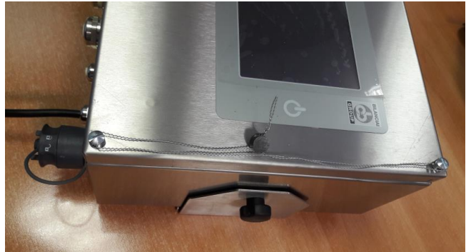
Typical wire sealing for DD1010 and DD1010 Skynet / Scellage de fil typique pour DD1010 et DD1010 Skynet
