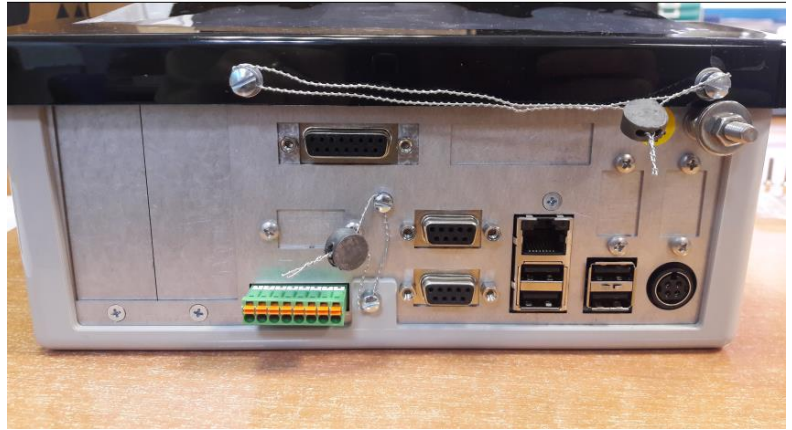
Typical wire sealing for DD1010 and DD1010 Skynet / Scellage de fil typique pour DD1010 et DD1010 Skynet
