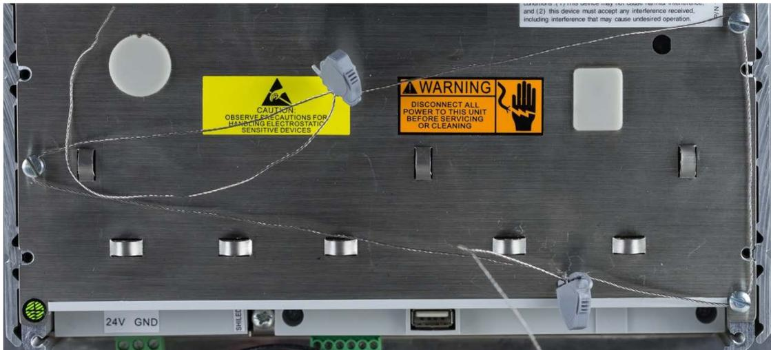
**Typical physical seal location for the panel mount / Emplacements typiques de sceaux physiques pour le montage sur panneau**
