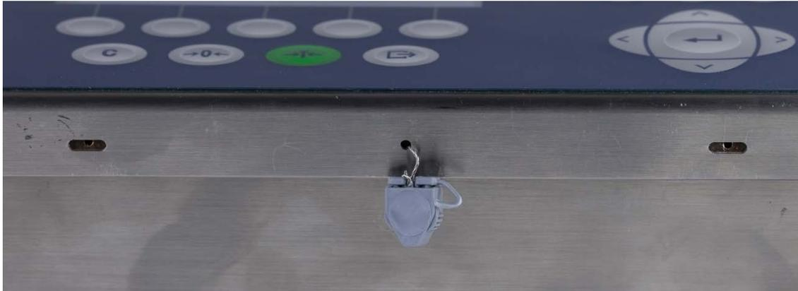
**Typical physical seal location for the harsh environment enclosure / Emplacement typique de sceau physique pour le boîtier pour un milieu agressif**
