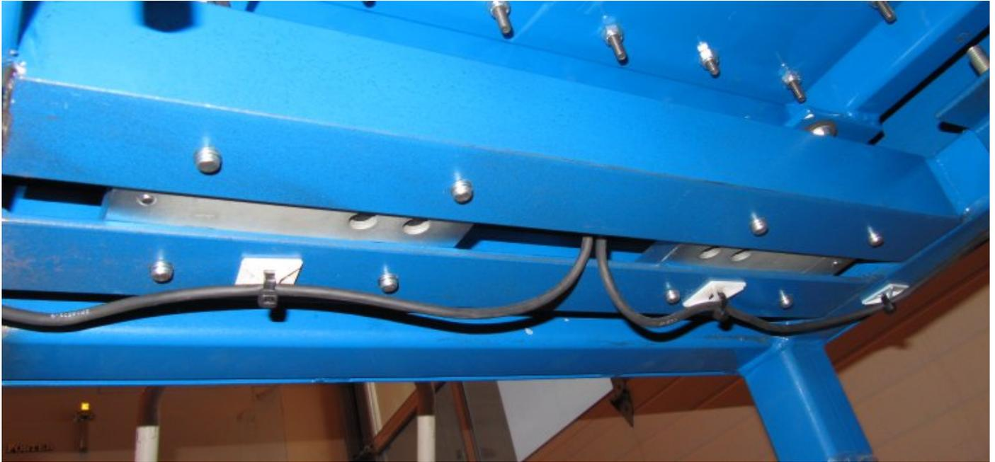
**Typical load cell mounting / Montage typique des cellules de pesages typique****SECTION 9 - Evaluated by**
