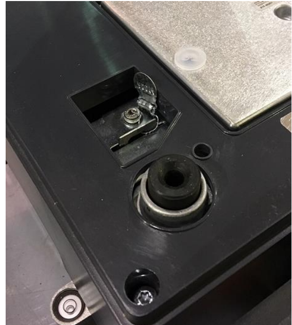
Typical XC 100, XC 100P, and XC 800 sealing location / Location du sceau physique pour les modèles XC 100, XC 100P et XC 800
