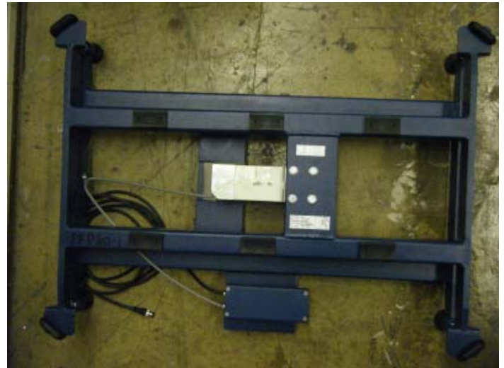
Typical frame of model PBD655 for capacities between 50 kg (100 lb) and 300 kg (500 lb) / Châssis de modèle PBD655 typique pour les charges entre 50 kg (100 lb) et 300 kg (500 lb)
